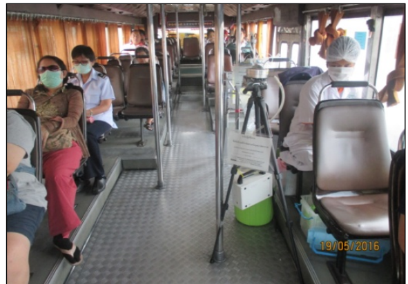
ภาพที่ 11-12 การเก็บตัวอย่างปริมาณแบคทีเรียรวม และปริมาณเชื้อรารวม
