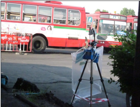
ภาพที่ 5-6 การเก็บตัวอย่างอนุภาคขนาดไม่เกิน 2.5 ไมครอน และอนุภาคขนาดไม่เกิน 10 ไมครอน
