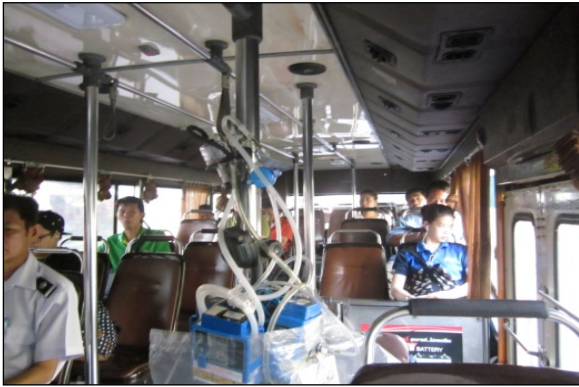
ภาพที่ 9-10 การเก็บตัวอย่างสารประกอบอินทรีย์ระเหยง่าย ประเภท BTEX ได้แก่ เบนซีน (Benzene), เอทิลเบนซีน (Ethylbenzene), โทลูอีน (Toluene) และไซลีน (Xylene)
