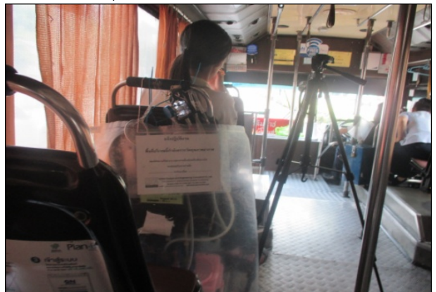
ภาพที่ 7-8 การเก็บตัวอย่างก๊าซคาร์บอนไดออกไซด์ และก๊าซคาร์บอนมอนอกไซด์
