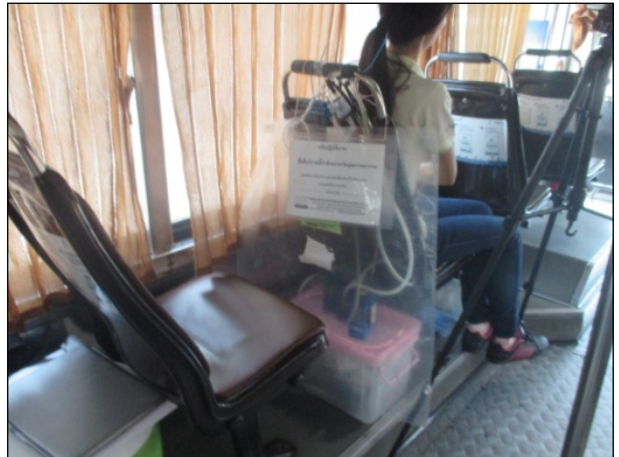
ภาพที่ 5-6 การเก็บตัวอย่างอนุภาคขนาดไม่เกิน 2.5 ไมครอน และอนุภาคขนาดไม่เกิน 10 ไมครอน
