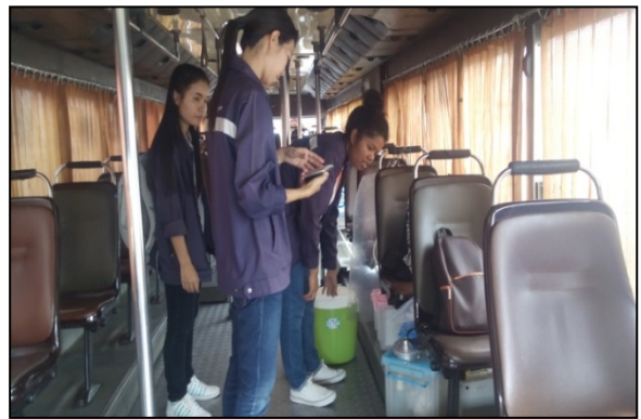
ภาพที่ 9-10 การเก็บตัวอย่างสารประกอบอินทรีย์ระเหยง่าย ประเภท BTEX ได้แก่ เบนซีน (Benzene), เอทิลเบนซีน (Ethylbenzene), โทลูอีน (Toluene) และไซลีน (Xylene)
