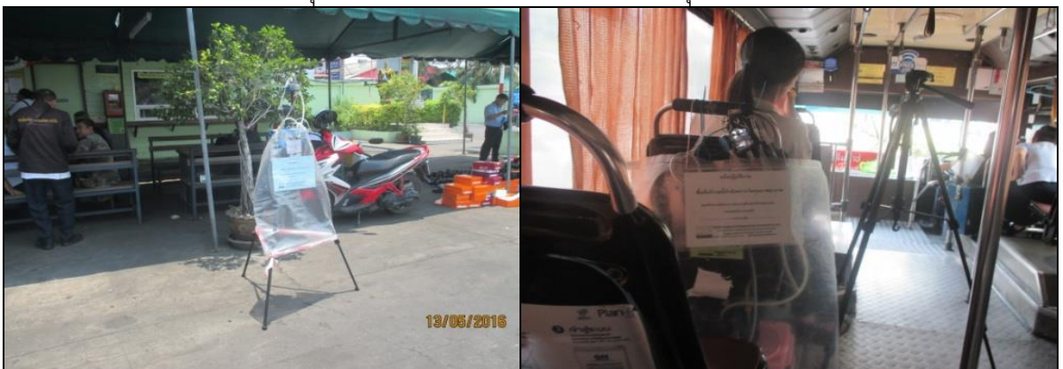
ภาพที่ 7-8 การเก็บตัวอย่างก๊าซคาร์บอนไดออกไซด์ และก๊าซคาร์บอนมอนอกไซด์
