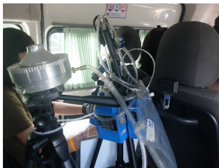
รูปที่ 3-6 ขั้นตอนการเก็บตัวอย่างก๊าซคาร์บอนไดออกไซด์ และก๊าซคาร์บอนมอนอกไซด์
