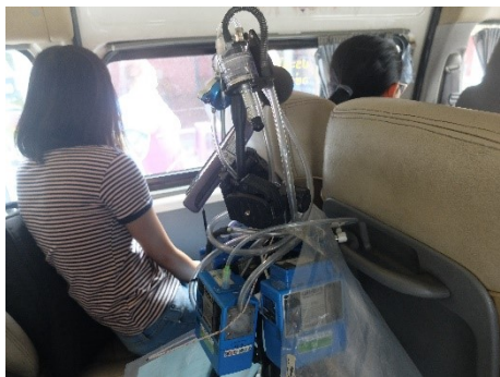
รูปที่ 3-6 ขั้นตอนการเก็บตัวอย่างก๊าซคาร์บอนไดออกไซด์ และก๊าซคาร์บอนมอนอกไซด์
