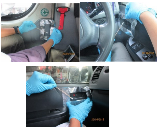
รูปที่ 3-8 ขั้นตอนการเก็บตัวอย่างปริมาณแบคทีเรียรวมในพื้นที่สัมผัส (บริเวณมือจับประตูด้านในห้องผู้โดยสาร คนขับรถ และคนนั่งด้านหน้า)
