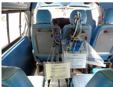
รูปที่ 3-5 ขั้นตอนการเก็บตัวอย่างฝุ่นละอองขนาดเล็กกว่า 2.5 ไมครอน และฝุ่นละอองขนาดเล็กกว่า 10 ไมครอน
