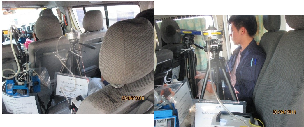
รูปที่ 3-9 ขั้นตอนการเก็บตัวอย่างปริมาณแบคทีเรียรวมและปริมาณเชื้อรารวมในอากาศ ที่ตำแหน่งกลางรถ
