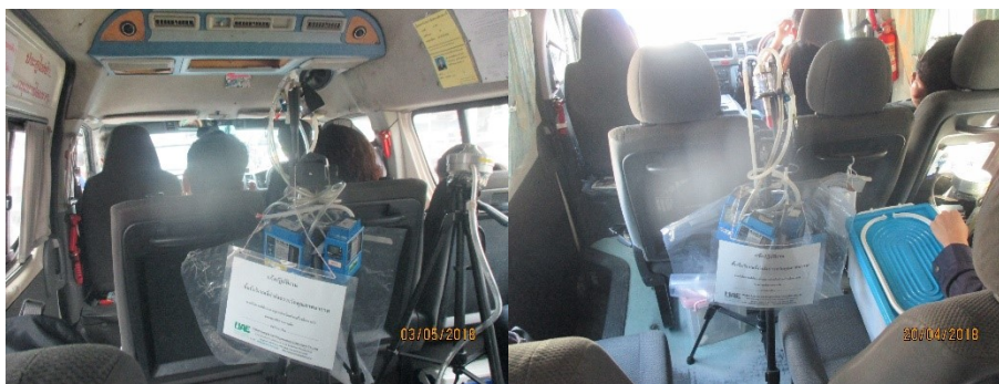
รูปที่ 3-7 ขั้นตอนการเก็บตัวอย่างสารประกอบอินทรีย์ระเหยง่าย ประเภท BTEX ได้แก่ เบนซีน (Benzene), เอทิลเบนซีน (Ethyl Benzene), โทลูอิน (Toluene) และไซลีน (Xylene) และไฮโดรคาร์บอน
