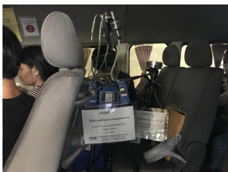
รูปที่ 3-5 ขั้นตอนการเก็บตัวอย่างฝุ่นละอองขนาดเล็กกว่า 2.5 ไมครอน และฝุ่นละอองขนาดเล็กกว่า 10 ไมครอน
