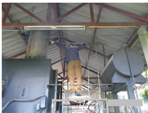
ภาพที่ 3-9 จุดเก็บตัวอย่างไดออกซินที่ระบายจากปล่องเตาเผามูลฝอยติดเชื้อ พื้นที่ศึกษาโรงพยาบาลในจังหวัดเชียงใหม่ แห่งที่ 1
