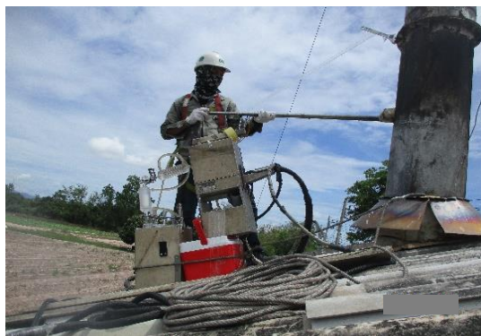
ภาพที่ 3-7 จุดเก็บตัวอย่างไดออกซินที่ระบายจากปล่องเตาเผามูลฝอยติดเชื้อ พื้นที่ศึกษาโรงพยาบาลในจังหวัดราชบุรี
