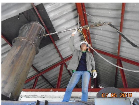
ภาพที่ 3-11 จุดเก็บตัวอย่างไดออกซินที่ระบายจากปล่องเตาเผามูลฝอยติดเชื้อ พื้นที่ศึกษาโรงพยาบาลในจังหวัดเชียงใหม่ แห่งที่ 2
